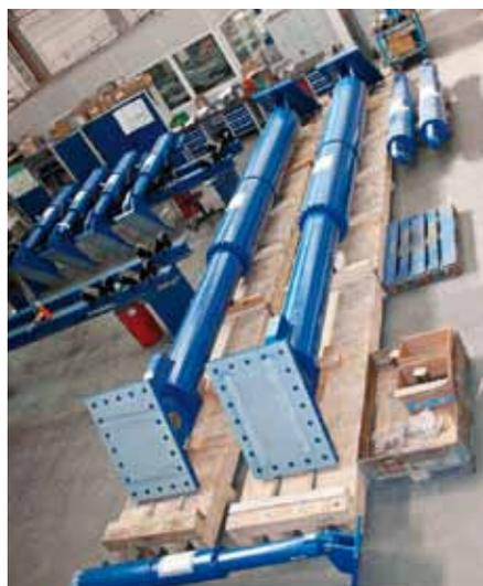
Amortiguadores hidráulicos MAURER fabricados en Múnich
