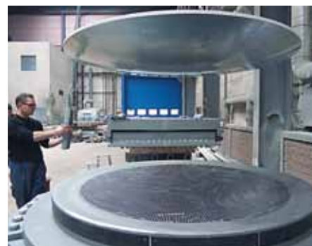
Apoyo esférico MSM® MAURER para una carga vertical de 220.000 kN
