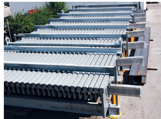
Wurden im Januar 2016 in die Türkei geliefert und sollen im März eingebaut werden: die 28-profiligen Dehnfugen.
