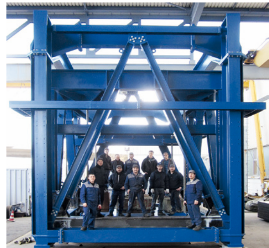
Das MAURER-Werksteam verdeutlicht die Größe des Stahlrahmens für das Doppelpendel in Baku.
