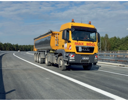
17 Lkw-Überfahrt zur Kalibrierung der Messtechnik © Hajo Dietz
