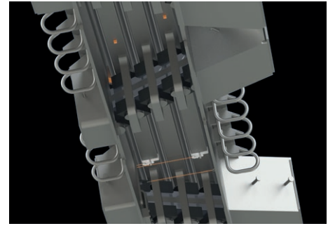
15 Weg- und Beschleunigungssensoren an den Lamellenprofilen © Maurer SE
