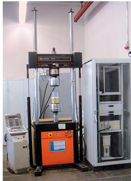
Bild 7 Hybrider Versuchsaufbau: Servo-hydraulische Zug-Druck-Prüfmaschine mit viskosem Dämpfer und Recheneinheit für die numerische Simulation Hybrid test setup: Servo-hydraulic tensile-compression-test rig with viscose vibration absorber and processing unit for numerical simulation
